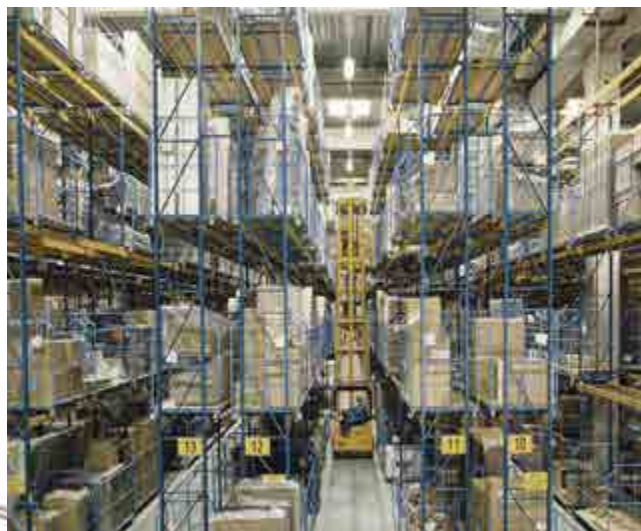
Regał paletowy (szerokość 2700 mm, głębokość 1100 mm)
